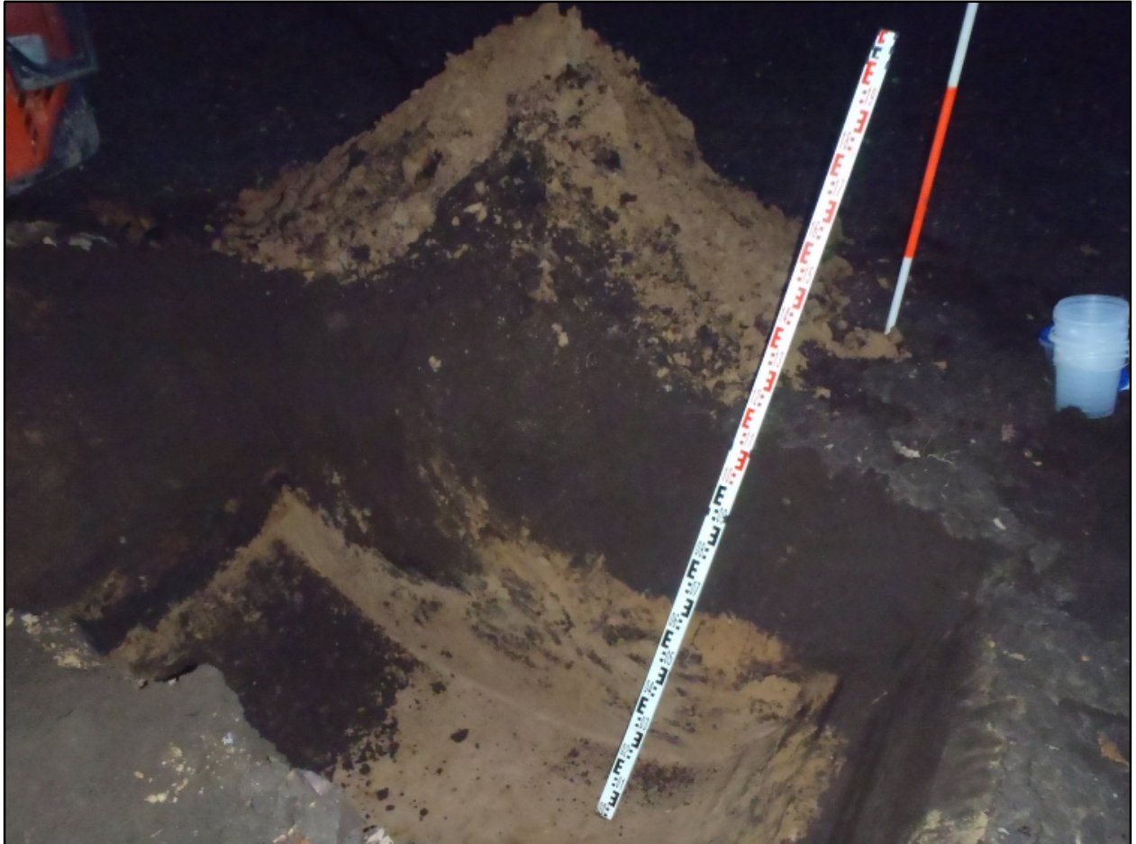
Abb. 5: Bodenschichtung in Schurf S 2
