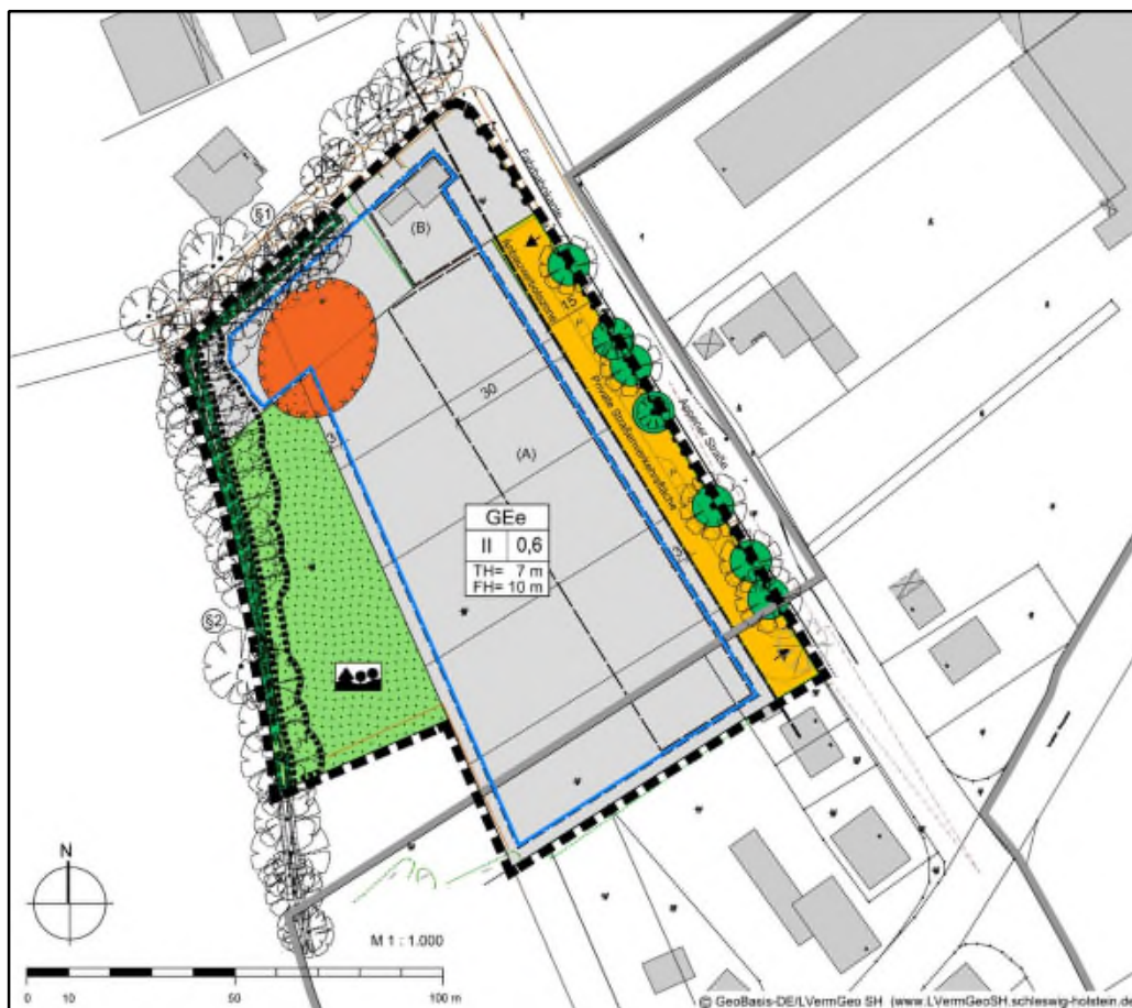
Abb. 1: Lage des vermuteten Verfüllungsbereichs (orange hinterlegt) M 1:2.000
